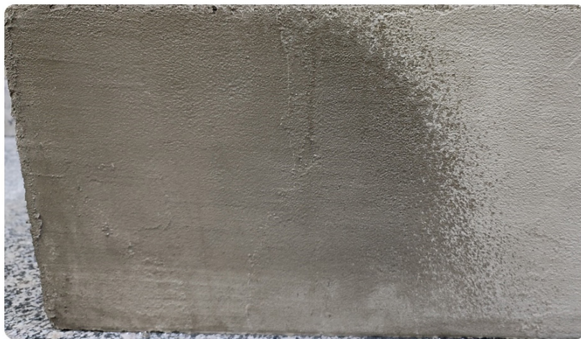
Рис. 13. Додаткове зволоження поверхні, обробленої гідроізоляцією Siltek VP-35.
