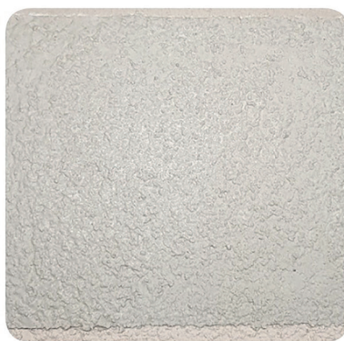
б) нанесення декоративної штукатурки Siltek P-15
